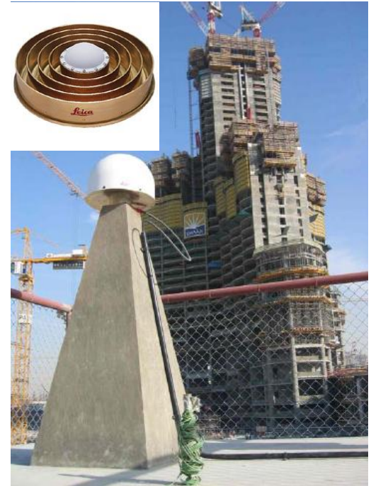
Stacja referencyjna GPS/GNSS
